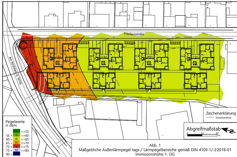
Die erforderlichen Schalldämm-Maße der Außenbauteile sind in Abhängigkeit von der Raumnutzungsart und Raumgröße im Baugenehmigungsverfahren gemäß DIN 4109-1:2018-01 und DIN 4109-2:2018-01 nachzuweisen.
