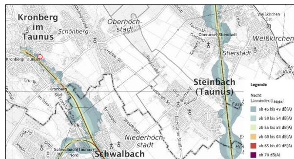
Abbildung 10 Umgebungslärmkartierung an Schienenwegen (Nacht)
