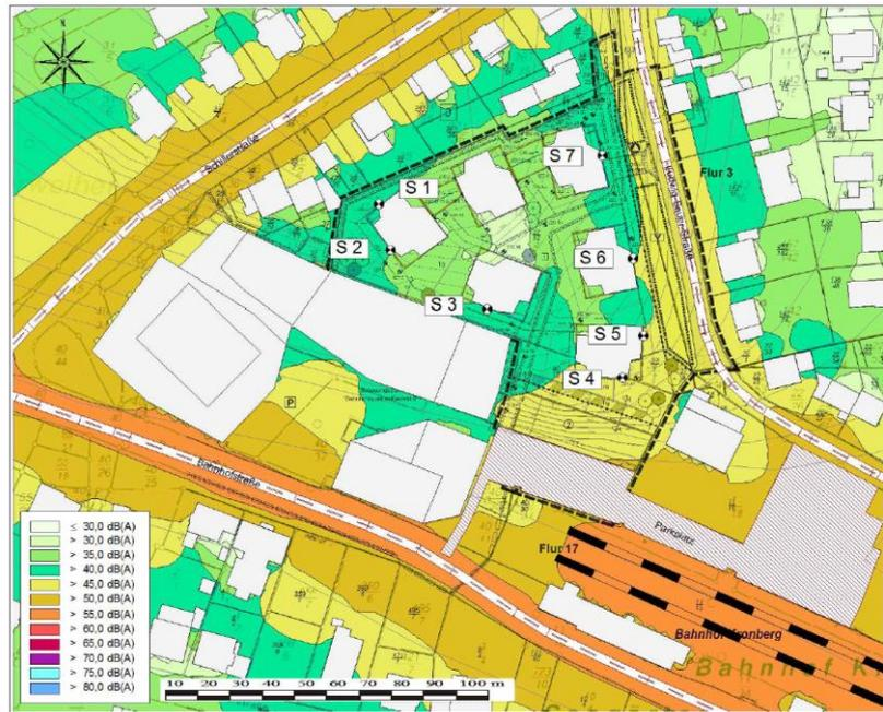
Abbildung 33: Lärmkarte mit Beurteilungspegel, Nachtzeit, Obergeschosshöhe (Quelle: W. Steinert, S. 36)
