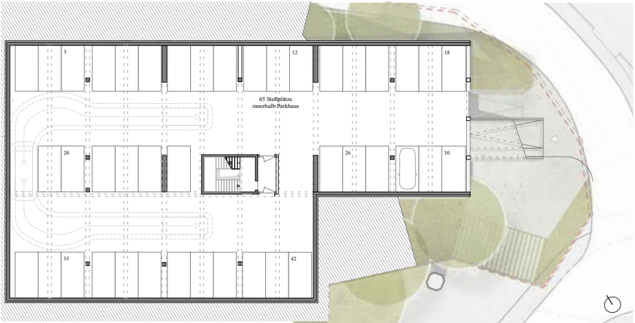
Grundriss Untergeschoss - Parkhaus M 1:200
